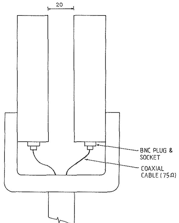
FIGURE 6 DIELECTRIC DUST PROBE
