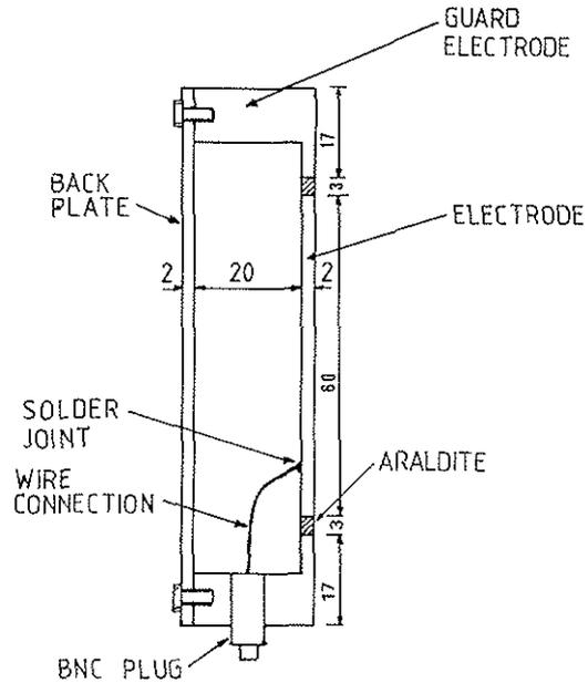
FIGURE 5 DIELECTRIC ANTENNA ASSEMBLY
